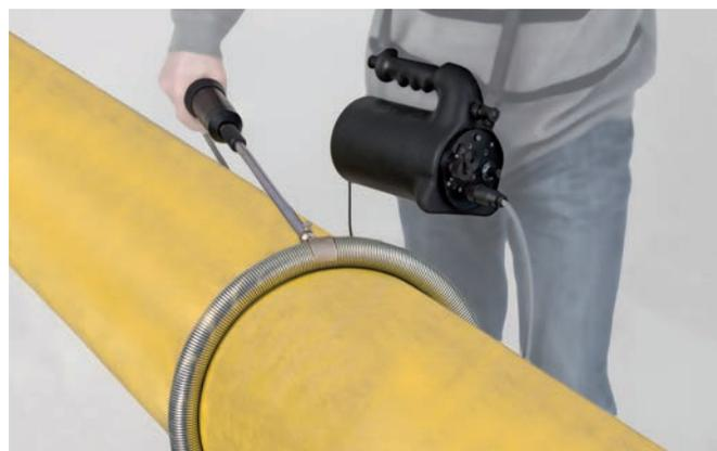
Bild 4: Einsatz an isolierter Rohrleitung
