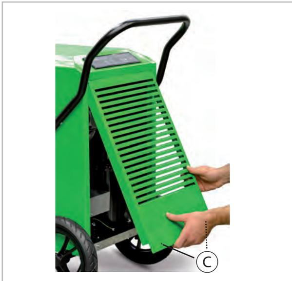
3. ➔ Die Lamellen des Kondensators entweder durch ausblasen, absaugen oder mit einer weichen Bürste bzw. einem weichen Pinsel reinigen.
