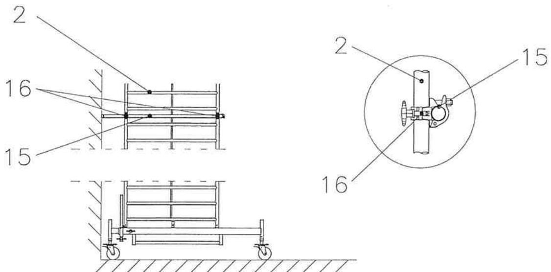
Bild 11 - Montieren der Wandabstützung bzw. Verankerung
