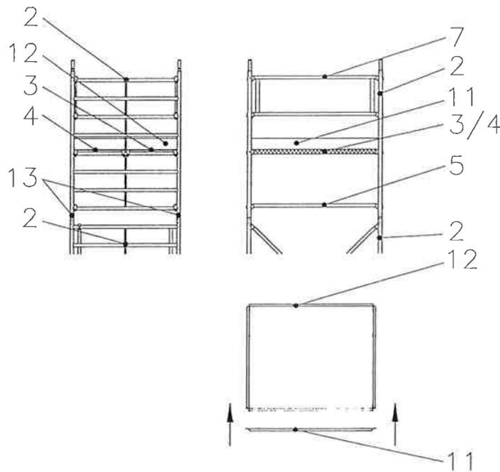
**Bild 10 - Aufbau der obersten Gerüstebene FG
