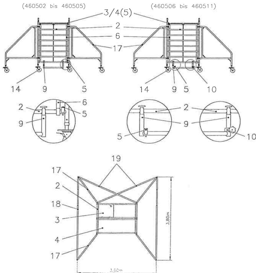
Bild 5 - Aufbau der untersten Gerüstebene mit Auslegern
