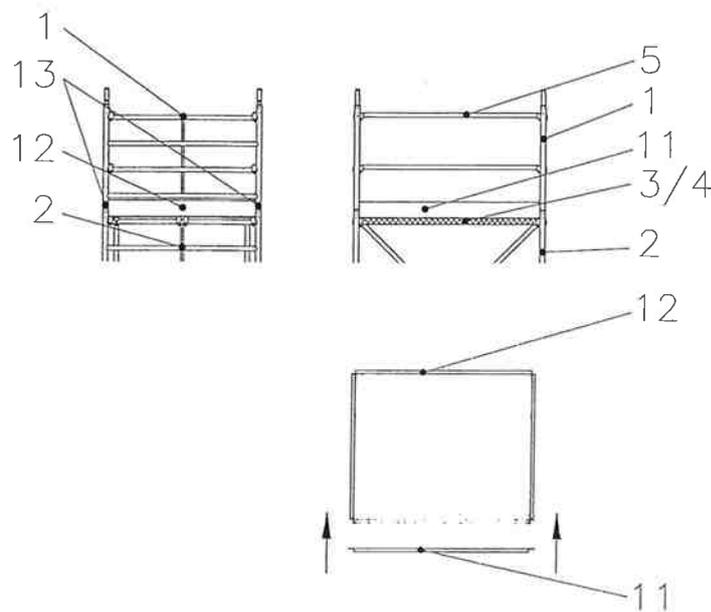
Bild 9 - Aufbau der obersten Gerüstebene FG
