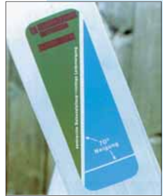
Aufkleber zur besseren Feststellung des richtigen Anstellwinkels
