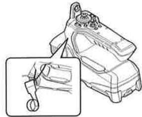
Wickeln Sie das Einführteil auf, und bündeln Sie es mit dem Befestigungsriemen in der Nähe des Abwinkelungsanschlags der Endoskopeinheit.
