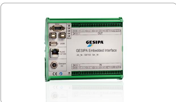
Das **GESIPA®-Interface**, eine Eigenentwicklung von GESIPA®, basierend auf einem Embedded PC-System, bietet 24 digitale Ein- und Ausgänge zum Steuern, eine Anschlussmöglichkeit an Ethernet über eine RJ45-Buchse sowie Status LEDs. Eine Anschlussmöglichkeit für einen Protokollkonverter für alle gängigen Bus-Systeme und Anschlussmöglichkeiten für externe Speichermedien sowie ein USB-Anschluss zur schnellen Datenübertragung runden die Features des neuen Interface ab.
