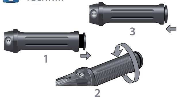
Ziehen Sie den Verriegelungsknopf am Griffende heraus und drehen Sie den Griff im oder gegen den Uhrzeigersinn, um das gewünschte Drehmoment einzustellen. Verriegelungsknopf wieder arretieren. Fertig!
