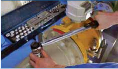
Auslösegenauigkeit: +/- 3% Toleranz vom eingestellten Skalenswert. Inklusive Prüfzertifikat nach DIN EN ISO 6789. Seriennummer auf dem Schlüssel und auf dem Zertifikat dient zur eindeutigen Produktidentifikation, rückführbar auf Nationale Normale.
