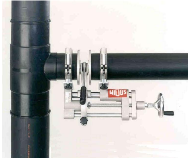
Einsatz der Maschine direkt im Rohrnetz
