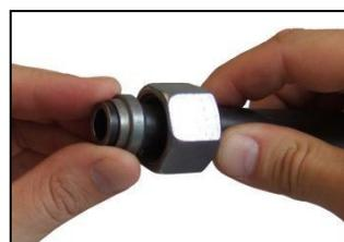
Position Schneidring, Überwurfmutter, Rohr
