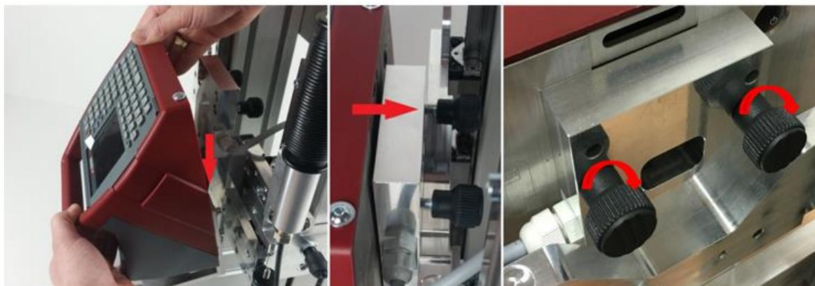
2. FlyMarker® PRO am Träger einhängen und mit 2 Rändel-Schrauben befestigen.
