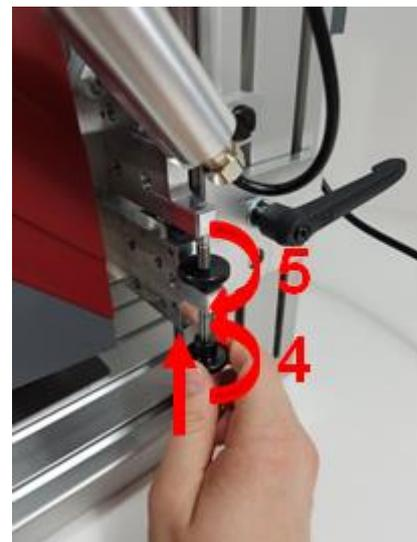
4. Einstellschraube nach oben gegen den mechanischen Anschlag drehen
