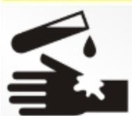
Bei falscher Anwendung kann Flüssigkeit aus dem Akku austreten. Vermeiden Sie den Kontakt damit. Bei zufälligem Kontakt mit Wasser abspülen. Wenn die Flüssigkeit in die Augen kommt, nehmen Sie zusätzlich ärztliche Hilfe in Anspruch.
