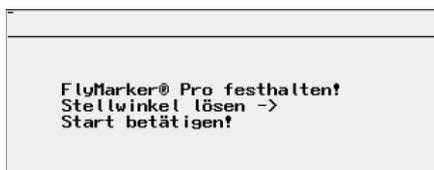
7. Nach erneutem Drücken des Startknopfs, wird die elektromagnetische Fixierung deaktiviert und der FlyMarker PRO kann wieder bewegt werden.
