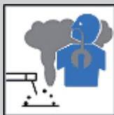
Beim Schweißen von besonders großen Teilen, die als geschlossener Raum oder Behälter angesehen werden können, muss sich der Bediener vor der Arbeit vergewissern, dass die Sauerstoffmenge (zwischen 19,5 und 23 % der Umgebungsluft) ausreichend ist. Die Benutzung eines Sauerstoffanalysegeräts wird dringend empfohlen.
