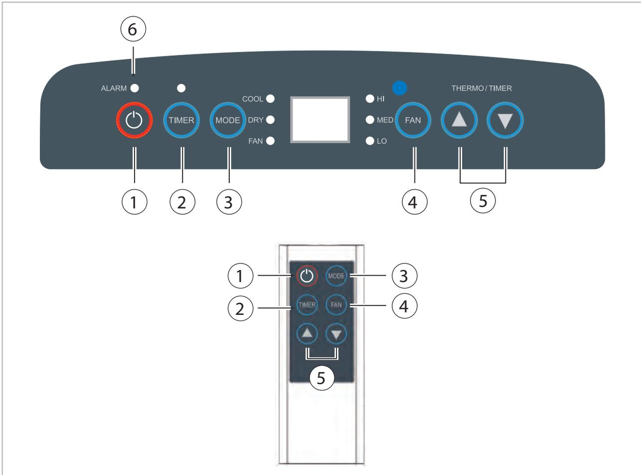
Abb. 3: Fernbedienung und Bedienungstableau
