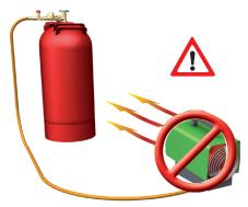
Um ein Vereisen der Gasflasche(n) zu vermeiden, ist die Gasversorgung entsprechend dem Anschlusswert des Gerätes. der Betriebsdauer und der Umgebungstemperatur der Versorgungsbehälter auszulegen.
