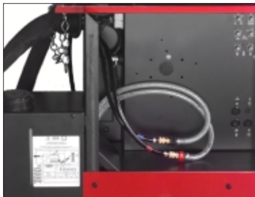
Abb.22 Montage der Kabel und Anschlüsse
