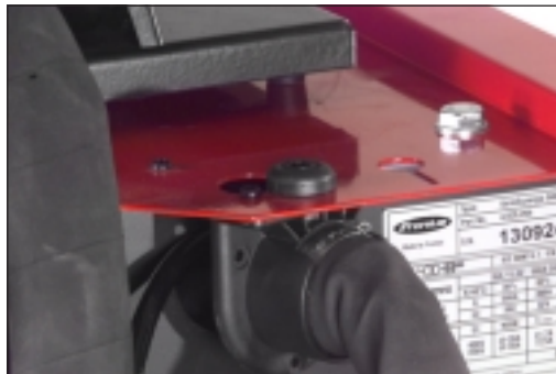
Abb.21 Montage des Verbindungs-Schlauchpaketes an der Stromquelle
