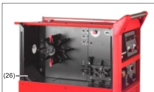
Fig. 15 Avant le montage du refroidisseur
