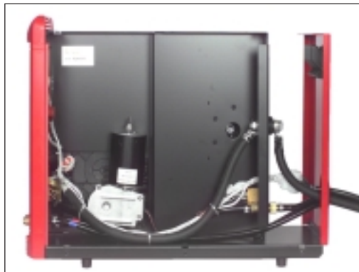
Fig. 24 Montage du faisceau de liaison au dévidoir VR 3300
