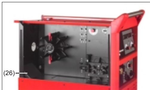
Abb. 15 Vor der Montage des Kühlgerätes
