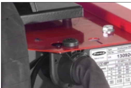
Fig. 21 Montage du faisceau de liaison à la source de courant
