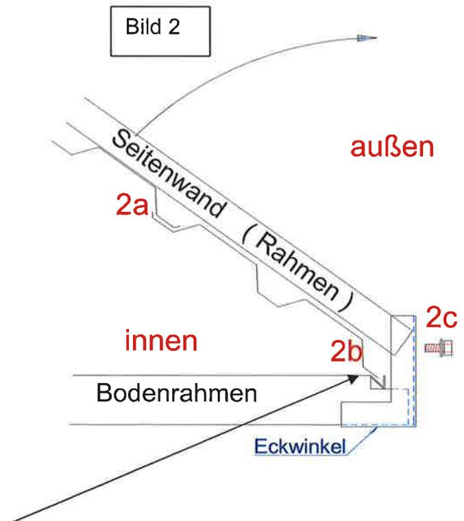
Unteres Seitenwandblech in das Bodenprofil einführen
