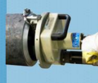
Tube beveler US40 : 43 ID – 219 mm OD 1.693" ID – 8.622" OD
