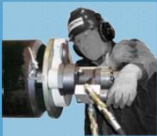
Tube beveler US80 : 80 ID – 406 mm OD 3.150" ID – 16" OD
