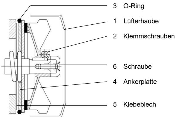
Bild 30: Aufbau der Fahrwerkbremse Typ EFB
