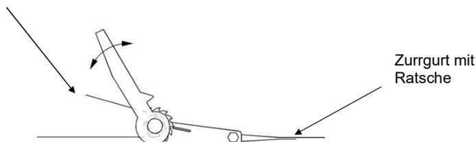
Bild 13: Schema des Einfädelns und des Spannens des Zurrurtes in der Ratsche
