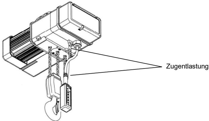
Bild 32: Befestigung der Zugentlastung
