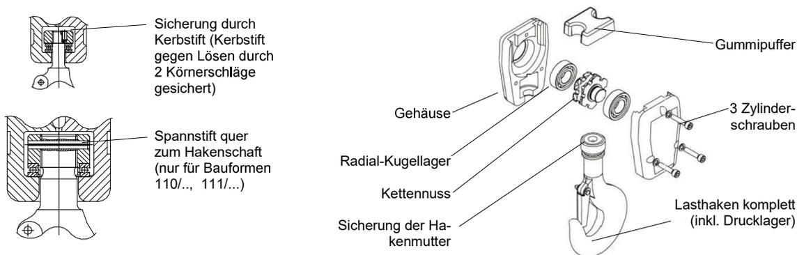
Bild 5: Aufbau der Hakenflasche
