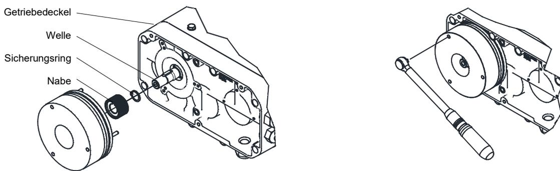
Montage der Federkraftbremse am Getriebedeckel
