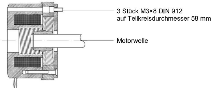
Bild 29: Aufbau der Fahrwerkbremse Typ BFK
