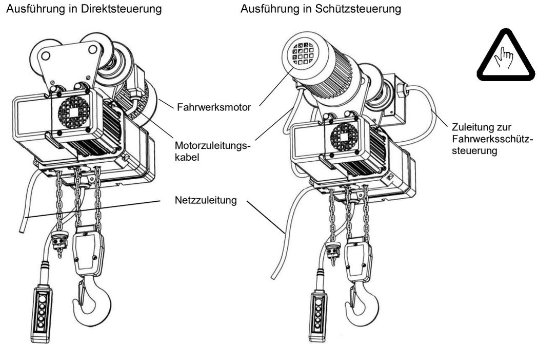
Bild 22: Anordnung des Fahrwerkes zum Elektrokettenzug
