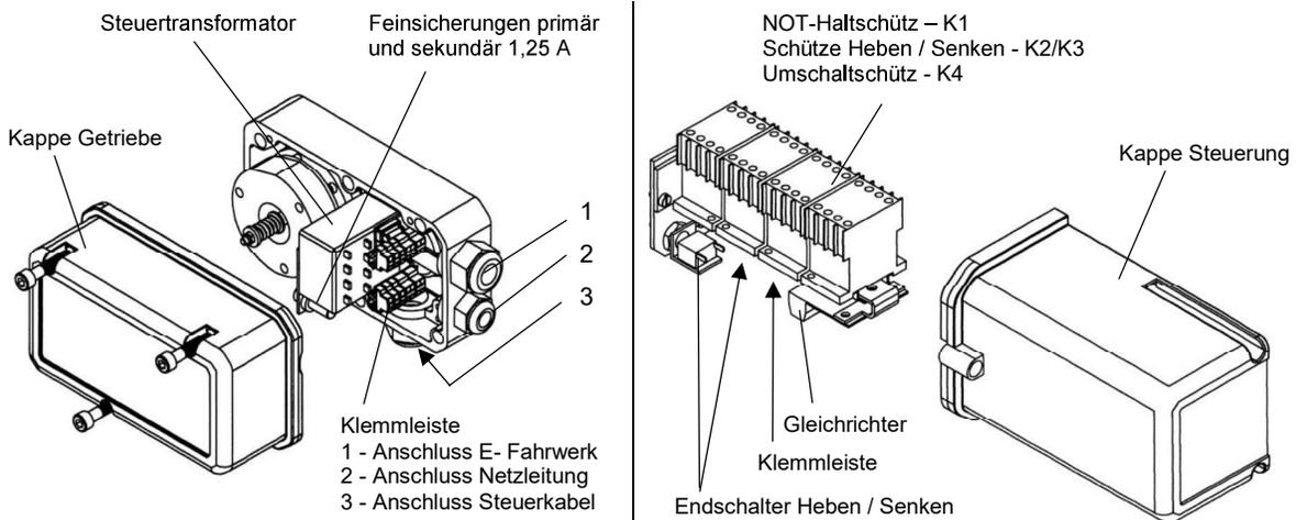
Bild 18: Schützsteuerung
