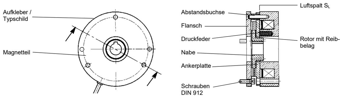
Bild 25: Aufbau der Federkraftbremse
