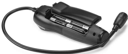
Kuva 4 – Paristokotelon kannen irrotus
