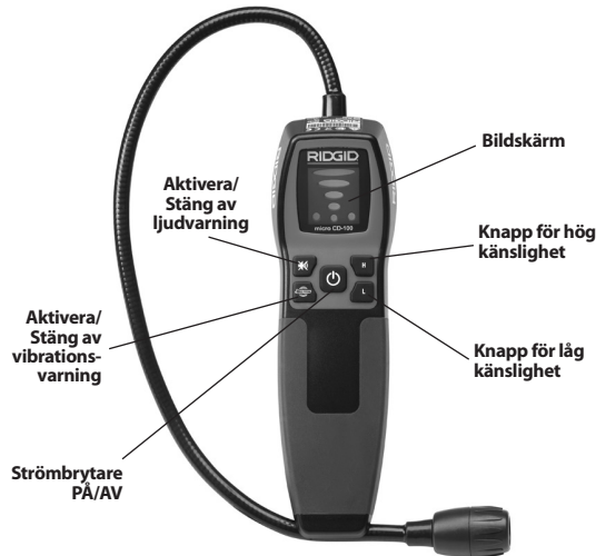
Figur 2 – Knappar på micro CD-100
