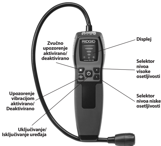
Slika 2 – Delovi uređaja micro CD-100
