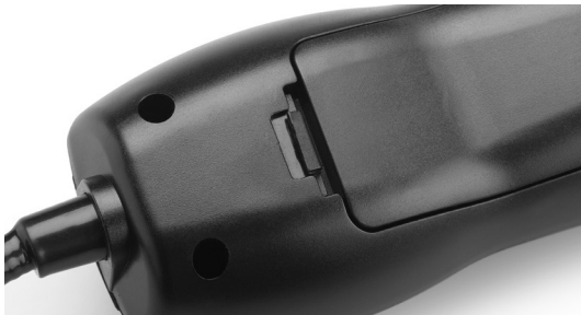
Εικόνα 5 - Άγκιστρο καλύμματος μπαταριών
