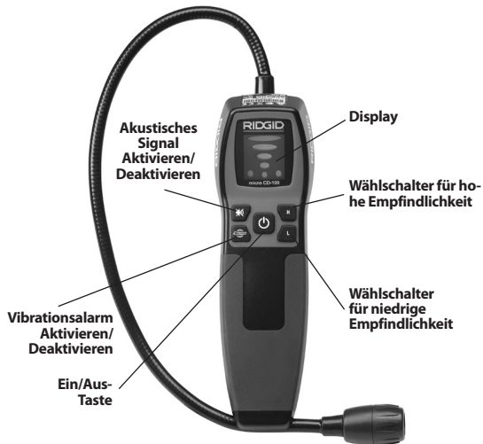
Abbildung 2 – Teile des micro CD-100
