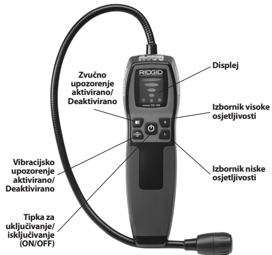
Slika 2 – Dijelovi uređaja mikro CD-100
