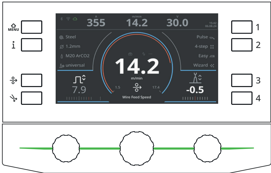
Bedienpanel mit Schweiß-Screen für MIG/MAG
