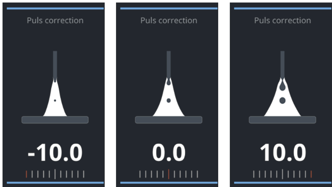
Beispiel: Schweißparameter Pulskorrektur -10 / 0 / +10
