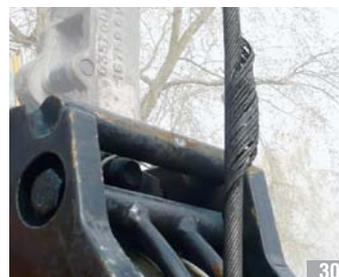
Durch Zuziehen einer Seilschlinge entstandene Klanke
