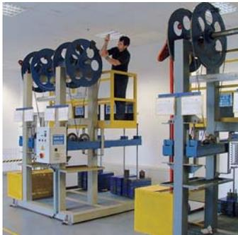
Prüfstände zur Ermittlung der Biegewechselfestigkeit.
