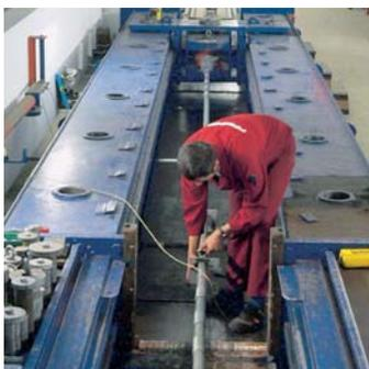
Zugprüfungsanlage mit einer Kapazität von bis zu 6000 kN zur Ermittlung der Seilsystembruchkräfte. Auch Zugschwellenversuche sind auf diesen Anlagen möglich.
