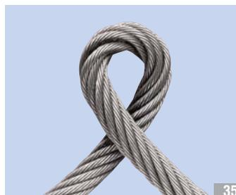
Durch mechanische Einwirkung entstandener Knick
