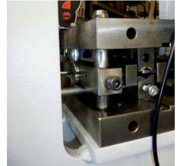
Prüfvorrichtung zur Messung der Querdruckstabilität.
